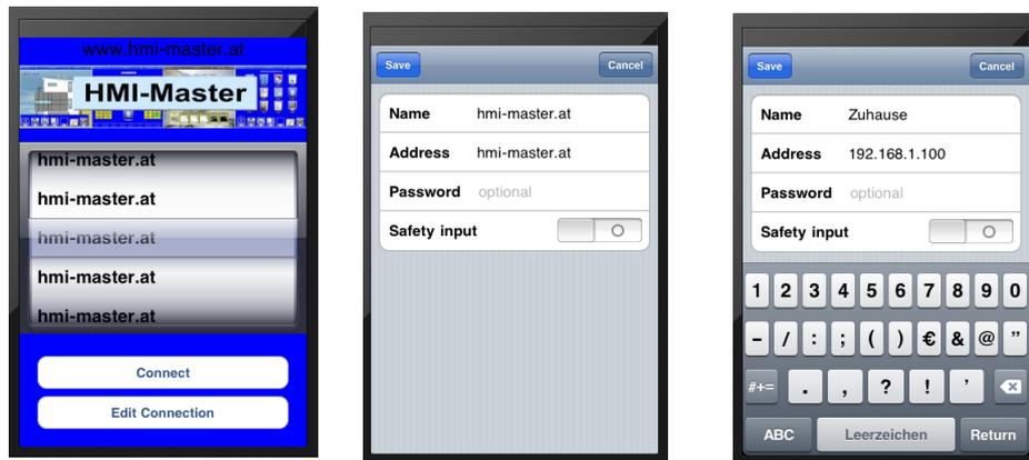
Im Startbildschirm wird dann der entsprechende Name in der Auswahlbox angezeigt, wählen Sie eine Verbindung aus und klicken auf Connect um eine Verbindung herzustellen.
